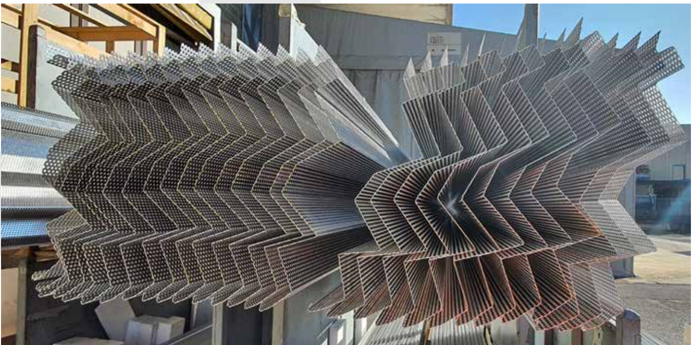
Pliage de formes complexes par commande numérique
